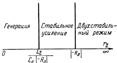
Рис. 25. Диаграмма различных режимов работы туннельного диода.
